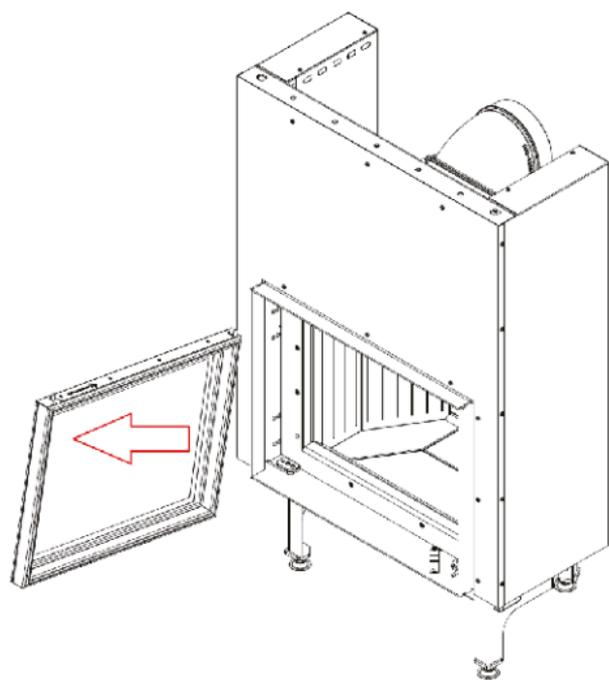
La procédure de démontage et de remplacement du déflecteur et de l' Termotec - la série **FRAM 1**.
