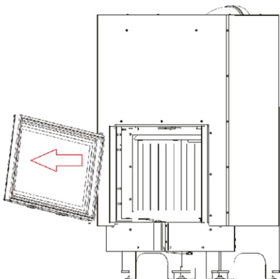
La procédure de démontage et de remplacement du déflecteur et de l'Termotec - les séries
